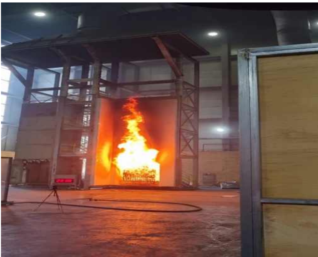
현 재 : 외벽 마감재료 실험대형 성능시험 시행
